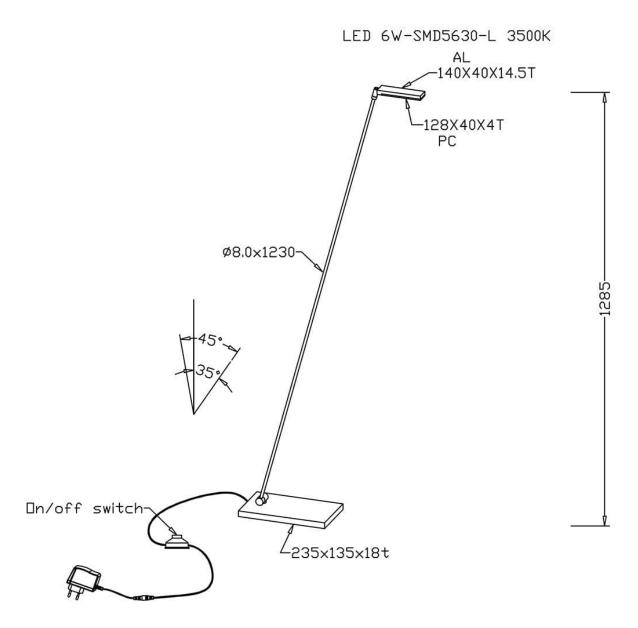
INPUT:AC 220~240V 50HZ DUTPUT:DC 24V 350mA
