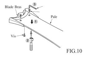
2. Fixez chaque ensemble de pales au corps du ventilateur à l'aide des vis des supports de pale. Serrez-les soigneusement.(Voir fig.11)
