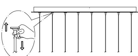
Avant l'installation au plafond, réglez appareils à la longueur désirée en appuyant sur fil vers le haut dans la canopée, puis enrouler l'excédent de fil, ajustement mineur peut être fait après installation. Pour abaisser ou rallonger le fil, appuyez sur le manchon du bouton situé à l'endroit où le fil sort de la canopée.
