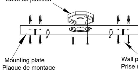
Assemblez la plaque de montage à la boîte de jonction et au plafond à l'aide des prise murale et vis fournies.
